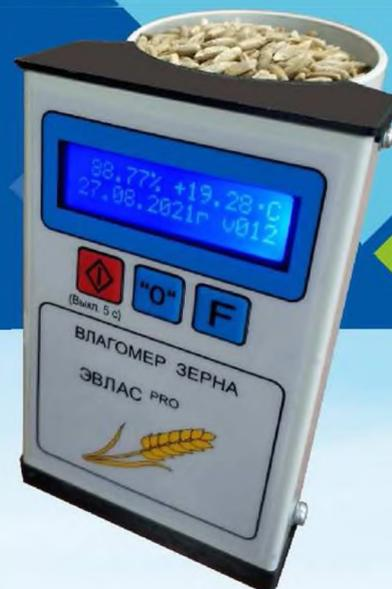
**ЭКОНОМИЯ ВРЕМЕНИ: ОПРЕДЕЛЯЙ ВЛАЖНОСТЬ БЕЗ РАЗМОЛА И ПРОБОПОДГОТОВКИ**
